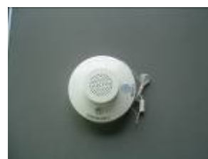
自動火災報知器
