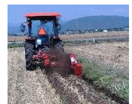
溝堀機 (額縁明渠施工)
