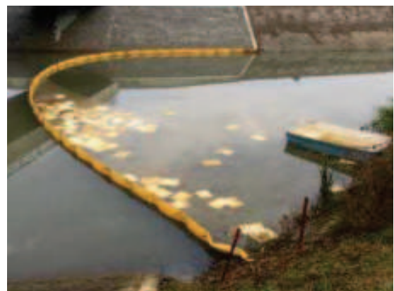
写真 油漏れ防止ネット
