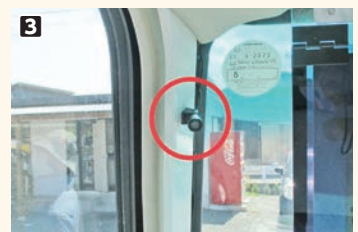
1 後部座席近くにあるアラームのストップボタン。エンジンを停止すると安全装置のアラームが鳴り、このボタンを押さないと止まりません
