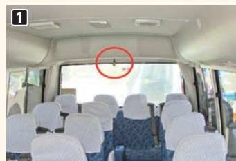
1 後部座席近くにあるアラームのストップボタン。エンジンを停止すると安全装置のアラームが鳴り、このボタンを押さないと止まりません
