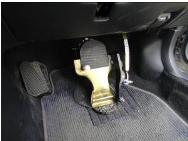
アクセルとブレーキを兼用する AT ワンペダル
