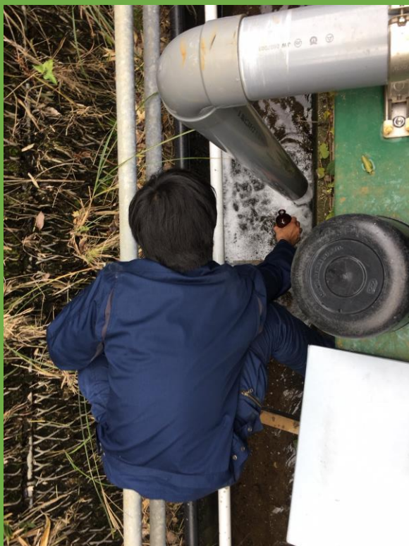
富士金属の工場排水を採水している様子
